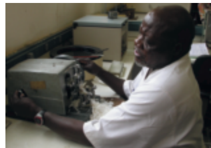
Fig. 7.9 A Luanda (Angola), ce technicien utilise un microtome pour préparer des lames histologiques. Les laboratoires d'anatomie pathologique restent rares dans bon nombre de régions d'Afrique sub-saharienne.
